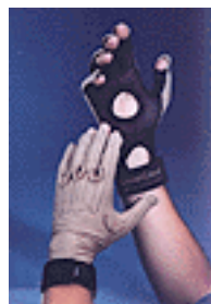
図 A.3 手の動作の入力装置 ; CyberGlove Fig.A.3: Hand gesture sensor; CyberGlove
