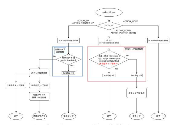
図 4.3: 逆タップインタフェースへ支持タップを実装したフロー
