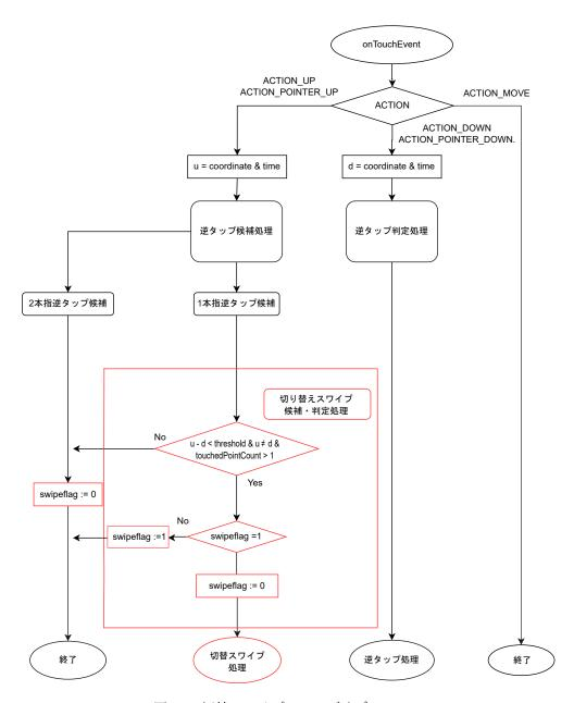
図 3.2: 切替スワイプのアルゴリズムフロー
