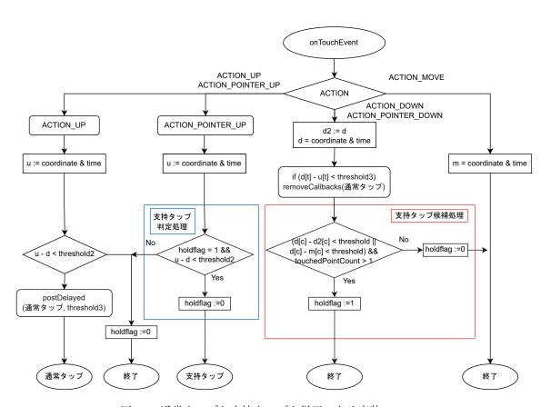
図 4.4: 通常タップと支持タップを併用できる実装のフロー
