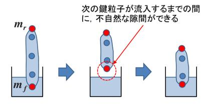
図 3.13: 落下液体と液面との隙間
