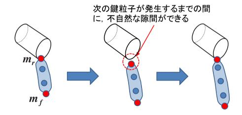
図 3.11: 落下液体と容器との隙間
