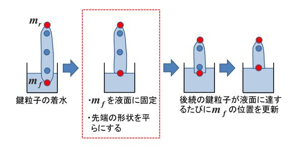
図 3.14: 落下液体と液面との接合
