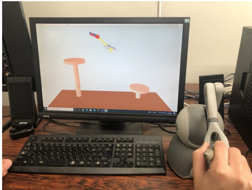
図 2.3: ペン型入力装置を操作し、画面上のマジックハンドを動かす様子
