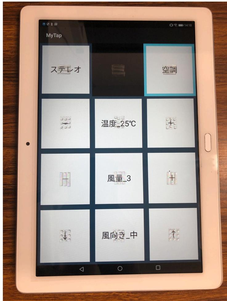
図 3.2: 突起物を付けたタブレットの様子 (空調画面)
