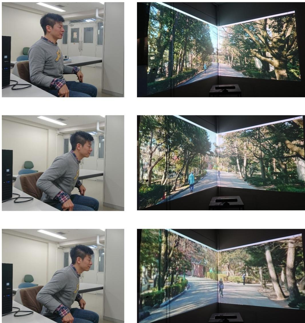
図 3.7: 前傾動作と映像シーン内での奥行き方向移動
